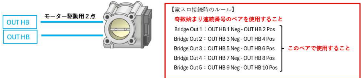
【図 7-2-2】 Boost コントロールソレノイド接続
